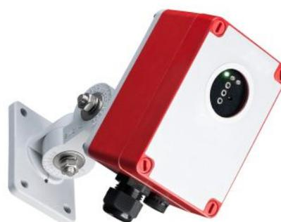
O suporte GFE-SWR-BKT (SM21) permite a montagem conveniente dos detectores de chama GFE-SWR. Através das marcações angulares existentes, é possível proceder ao correcto alinhamento do detector com os riscos existentes. O suporte GFE-SWR-BKT (SM21) é adequado para ambientes categorizados como Explosivos (Ex).
