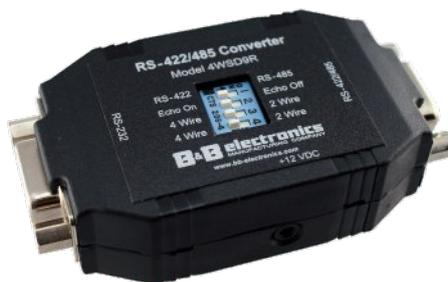
Este conversor é utilizado no PC, para converter o nível do sinal de RS485 para RS232, quando as centrais analógicas endereçáveis GFE são interligadas com o software ODYSSEY através desta tecnologia. O conversor é alimentado directamente pela porta série, logo não necessita de alimentação auxiliar.
